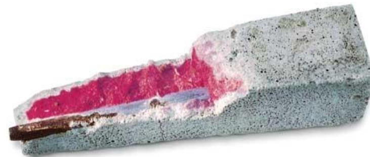
Tests de fenolftaleína y de cloruros para ver el estado del hormigón
