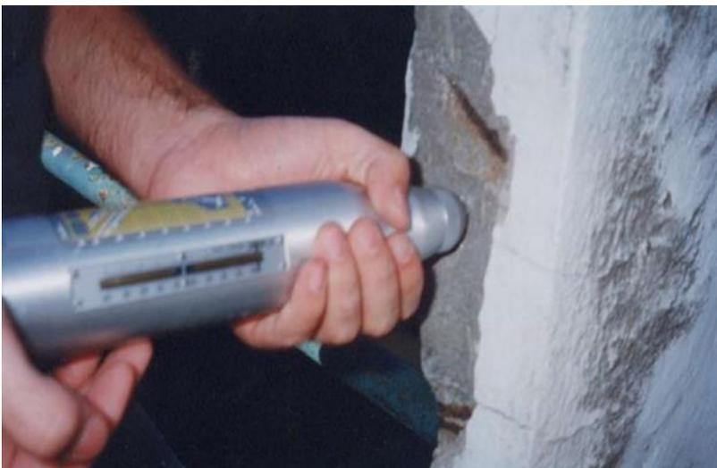
Ensayo con esclerómetro para determinar la resistencia a compresión del hormigón
