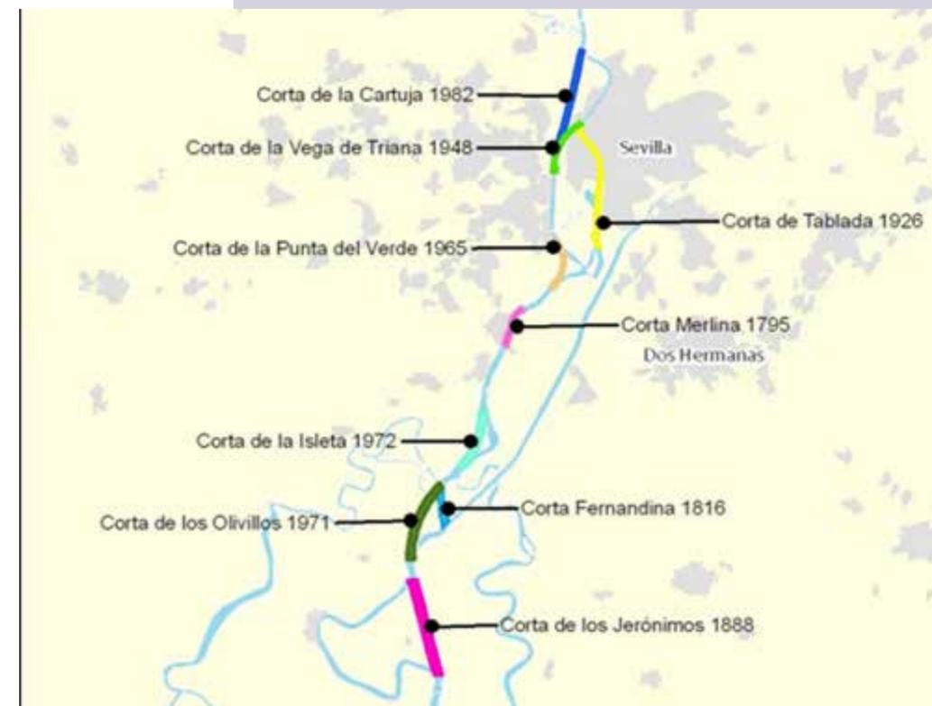
**FIGURA 6.** Esquema de las aguas de transición. Cuenca del Guadalquivir con las rectificaciones de meandros. CHG 2009
