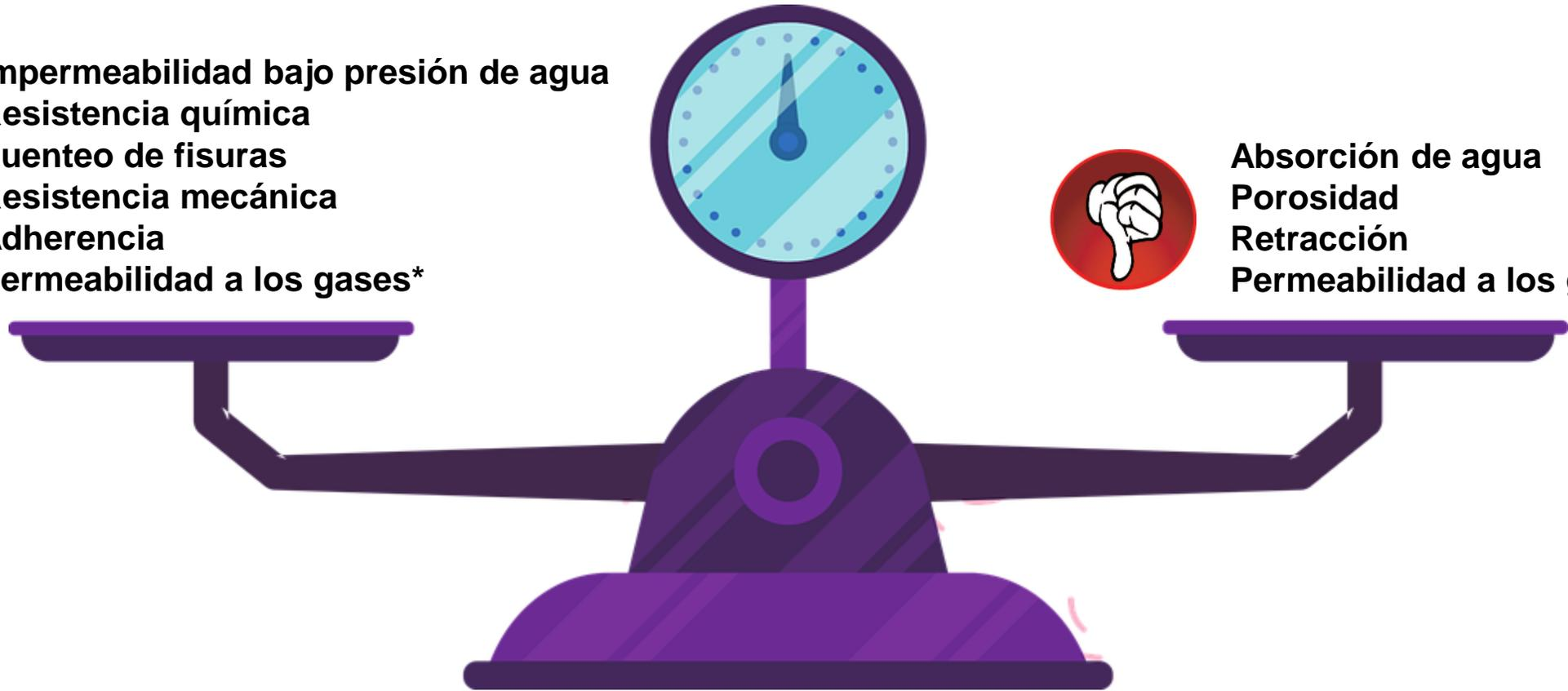
A mayor permeabilidad a los gases, menor riesgo de condensaciones pero mayor paso de vapor de agua (humedad), CO<sub>2</sub>, Radón, etc.
