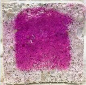
Decisión sobre tipo de actuación basada en la profundidad de carbonatación respecto de la posición de las armaduras
