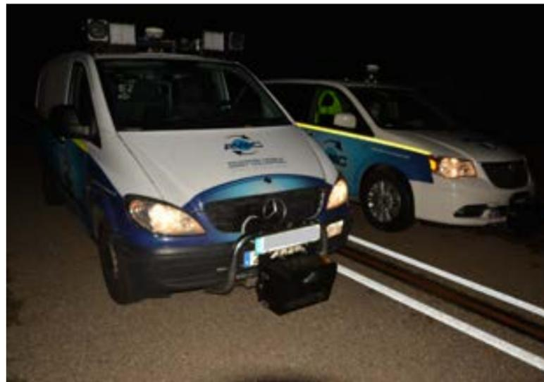
Arriba, Vehículos para la toma de datos de señalización vertical. Abajo, Visor de AMAC para ver la señalización vertical inspeccionada.
