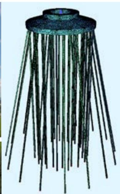
Modelo de cimentación de torre eólica pilotada.
