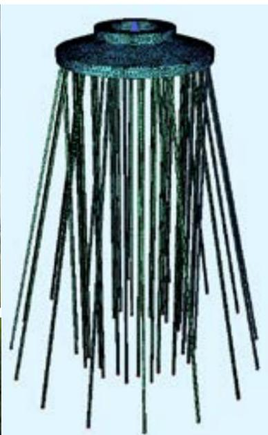
Modelo de cimentación de torre eólica pilotada.
