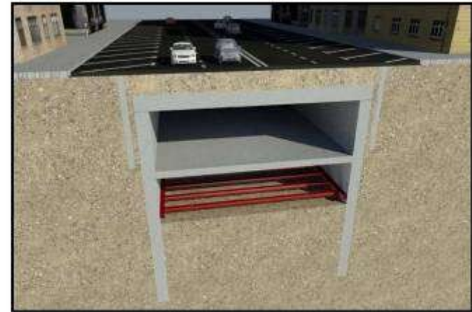
FASE 10: EXCAVACIÓN HASTA COTA DE PUNTALES Y DISPOSICIÓN DE PUNTALES PROVISIONALES
