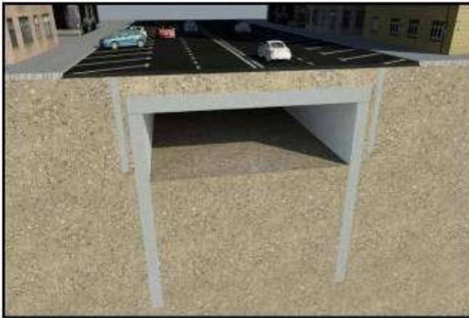
FASE 8: EXCAVACIÓN HASTA COTA INFERIOR DE LOSA DE NIVEL DE VESTÍBULO
