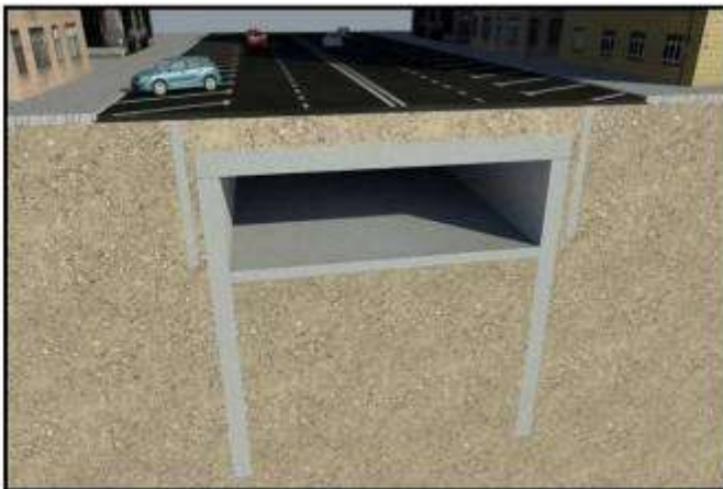
FASE 9: EJECUCIÓN DE LOSA DE NIVEL DE VESTÍBULO
