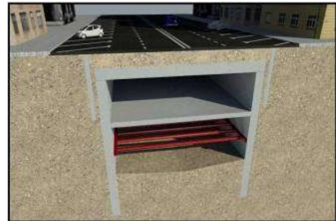
FASE 11: EXCAVACIÓN HASTA COTA INFERIOR DE CONTRABÓVEDA
